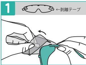
1 レンズ片面の剥離テープを持ち、保護フィルムを1つ目の穴まではがして、フレームの一番端の凸部に取り付けます。
